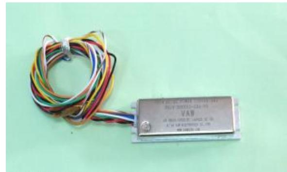
15V, 18V, 24V, 36V, 48V。FHS18 输出电压有 0.9V, 1.25V, 1.5V, 1.8V, 2.5V, 3.3V, 5V, 7V, 9V, 12V, 15V, 18V, 24V, 36V, 48V。即可以输出它们其中的一路, 也可以是它们之中的任意两路, 三路或四路组合! MOUT 端输出的是主输出, OUT1 和 OUT2 端输出的是辅助输出! 使用的时候, 主输出 MOUT 端输出的电压最稳定, 主输出一般是正负对称的, 也可以是一路或两路不对称的, 主输出之间不隔离, 主输出和辅助输出之间是隔离的! 主输出如果是正负对称的, 正负两路都采样反馈稳压, 它的电压要求大或等于 3.3V! 主输出如果是两路不对称的, 一路采样 80% 反馈稳压! 一路采样 20% 反馈稳压! 必须有一路的电压要大于 5V! 主输出的输出功率被要求是四路输出里最大的。
