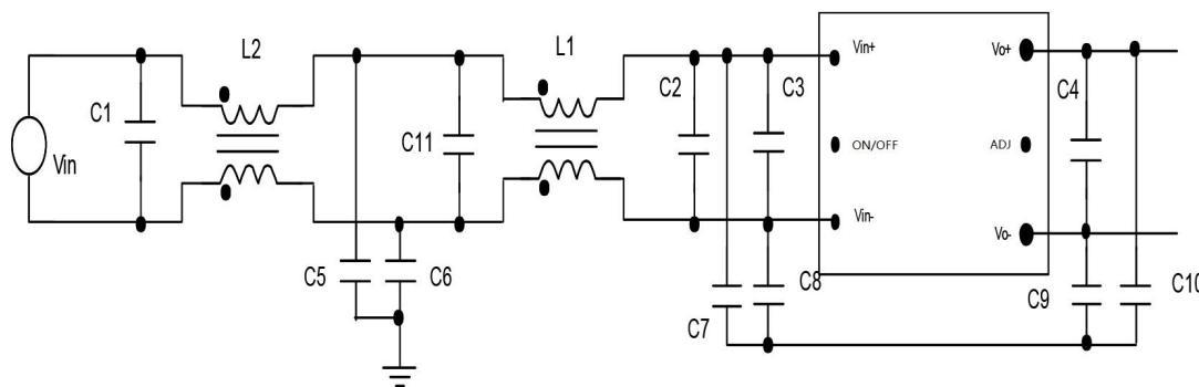
C1, C2, C3, 和 C4 为差模滤波电容。其中 C2 应为低等效串联电阻 (ESR) 的较大容量的电容 (如电解电容)；C1, C3, 和 C4 一般均为等效串联电阻和等效串联电感 (ESL) 都很小的陶瓷电容，为高频噪声电流提供低阻回路。关于 C2 容量的选择，对输入最低电压为 120V 的模块，建议每 100 瓦输入功率用 22–47uF，对输入最低电压为 30V 的模块，建议每 100 瓦输入功率用 50–100uF；对输入最低电压为 18V 的模块，建议每 100 瓦输入功率用 200–400uF。电容的电压等级应大于最高的输入电压。C2 还须有足够的电流定额以满足高温大负载长期运行的需要。C2 的主要功能是防止模块输入端的供电电源输出阻抗过高，以保证在各种实际的条件下模块均能稳定运行。如果供电电源的输出阻抗较低，距离模块较近，C2 的容量也可以适当减小。C2 在保证稳定性的同时也为模块产生的输入纹波电流提供了一个通路。电容 C7 – C10 是共
