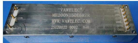
内部所有的元器件都选用耐200°C以上高可靠, 超长寿命的元器件。在工作环境温度175°C, 壳温不超过185°C的严酷条件下, ME200在保证失效率不超过0.5%情况下可连续或累计工作时间超过500或1500小时 (E档: 500小时, T档: 1500小时)。ME200具有输出过流、短路及输入欠压和过温保护等功能。环境性能满足 GJB150-86相关要求, 电气性能指标符合 GJB-181A-2003 标准, 其精细的设计保证了具有卓越的热性能和极高的稳定性, 能够满足对尺寸、重量、功率密度、环境等要求比较高的需求, 从而广泛应用于各种对环境和质量要求严苛的电子系统。
