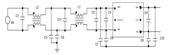
C1, C2, C3, 和 C4 为差模滤波电容。其中 C2 应为低等效串联电阻(ESR)的较大容量的电容(如电解
