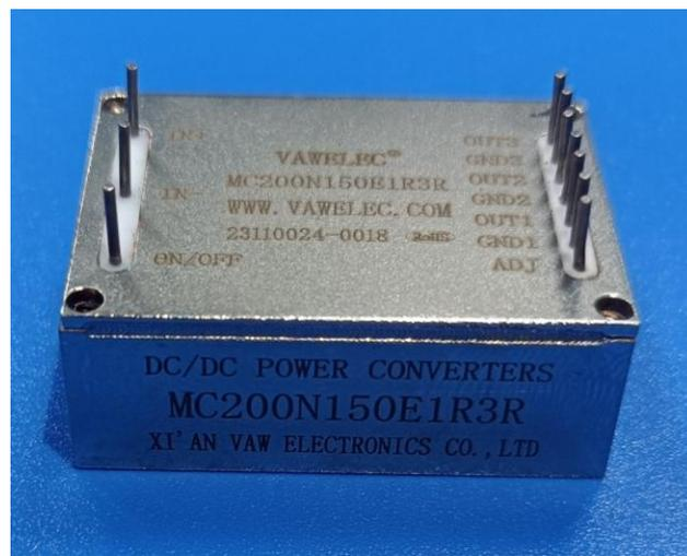
模块内部所有的元器件都选用耐 +200℃ 以上高可靠，超长寿命的元器件。在工作环境温度 +175℃，壳温不超过 +185℃ 的严酷条件下，MC200 在保证失效率不超过 0.5% 情况下可连续或累计工作时间超过 500 或 1500 小时（E 档：500 小时，T 档：1500 小时）。MC200 具有输出过流、短路及输入欠压和过温保护等功能。环境性能满足 GJB150-86 相关要求，电气性能指标符合 GJB-181A-2003 标准，其精细的设计保证了具有卓越的热性能和极高的稳定性，能够满足对尺寸、重量、功率密度、环境等要求比较高的需求，从而广泛应用于各种对环境和质量要求严苛的电子系统。
