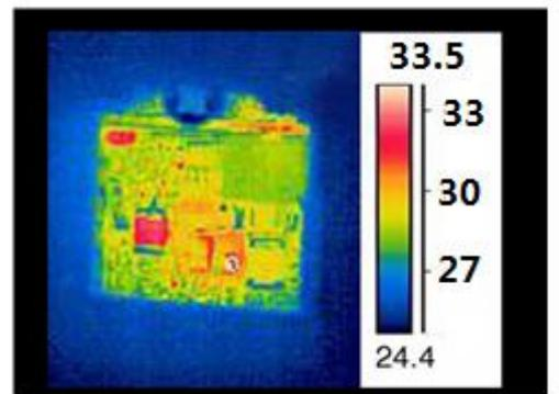
FHV10系列选用的所有器件结温都大于+200°C! 设计时采用了目前最好的热设计! 右图是FHV10系列的热成像图, 由图可看出它在散热良好的情况下温升只有九度, 所以可以在+175°C的环境温度下长时间的可靠工作! 但是当芯片的结温超过+204°C时, 芯片的过温保护电路被激活, 它开始减少输出功率, 直到+210°C输出功率减为零! 温度迟滞到+195°C时, 过温保护电路休眠, 模块又开始输出功率!
