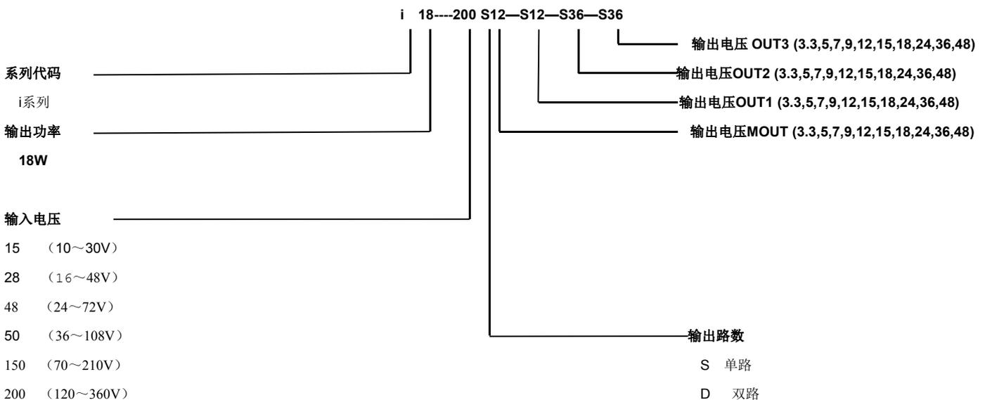
说明: 型号里的 {—} 是表示隔离的意思。输入和输出之间一直是隔离的, 所以第一个 {—} 是必须的! 后面的三个 {—} 可以不出现或出现一到三个, 表示输出之间的不隔离或隔离! S\*\*\* 也可以是 D\*\*\* 或 S\*\*\*S\*\*\*! 一个型号里最多四个 S\*\*\*。D\*\*\* 表示两个 S\*\*\*!
