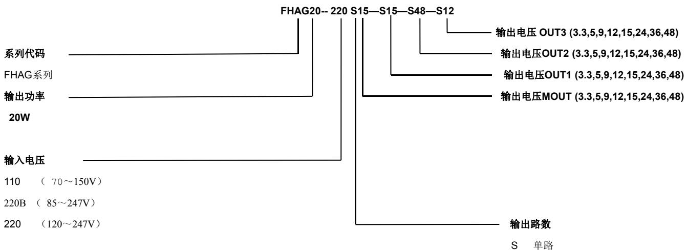
说明：型号里的—表示是隔离的意思。如果是单路输出的话，就没有 —SOUT1—SOUT2—SOUT3，如果是双路输出，就没有--SOUT2-SOUT3，如果是三路输出，就没有—SOUT3。
