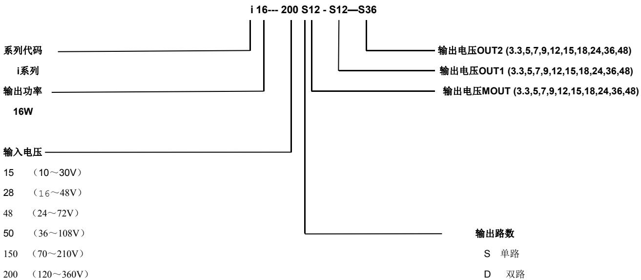
型号举例：i16-150D15S5 的型号 MOUT 输出为 +15V, OUT1 为 -15V! OUT2 为 +5V, 输出之间共地！
